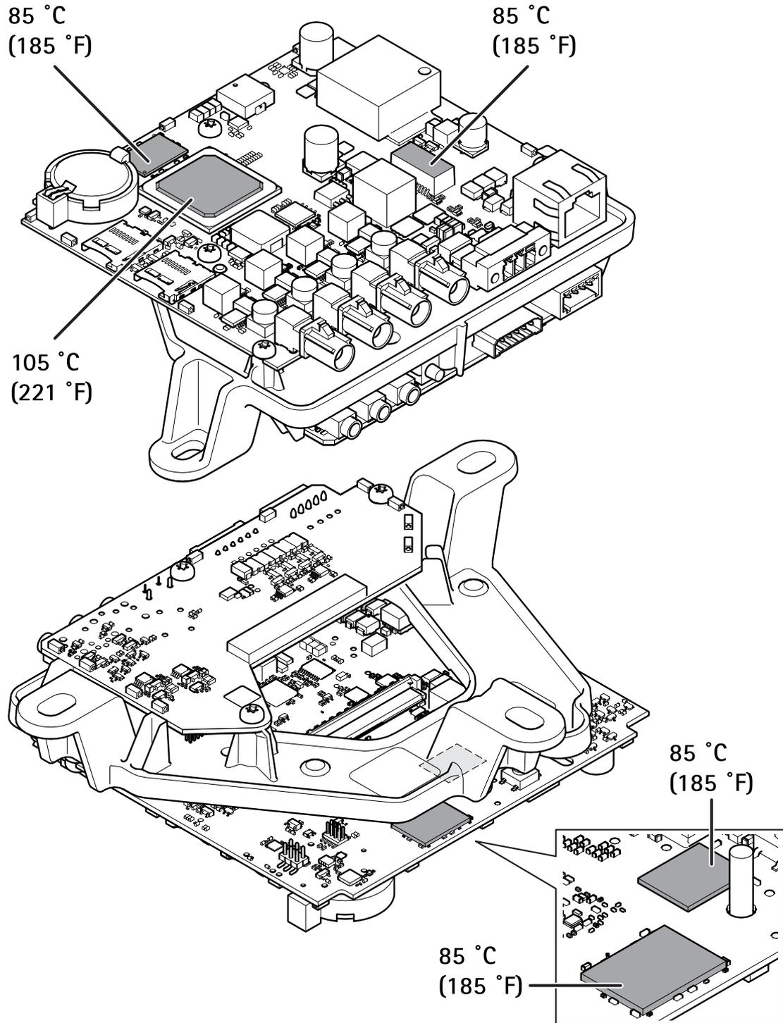
最大許容温度。周囲温度が35 °C以上の場合、コンポーネントの温度が上昇するため、コンポーネントを冷却する必要があります。
