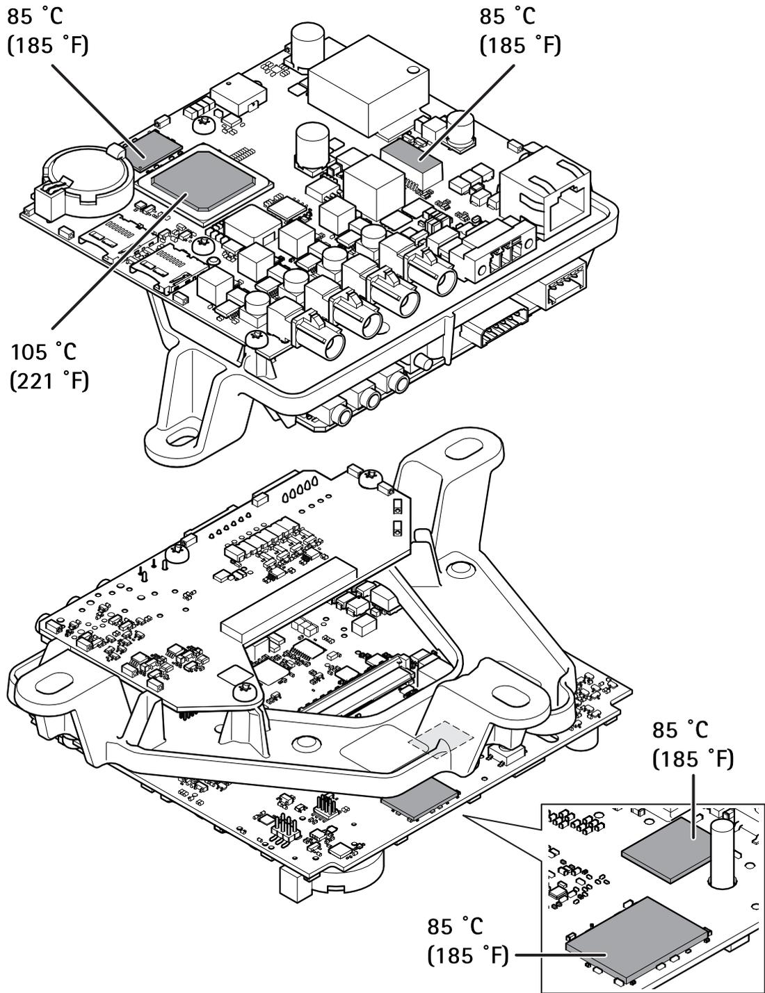
1 Maximal zulässige Temperaturen. Wenn die Umgebungstemperatur 35 °C oder höher beträgt, steigt die Temperatur der Komponenten und sie müssen gekühlt werden.
