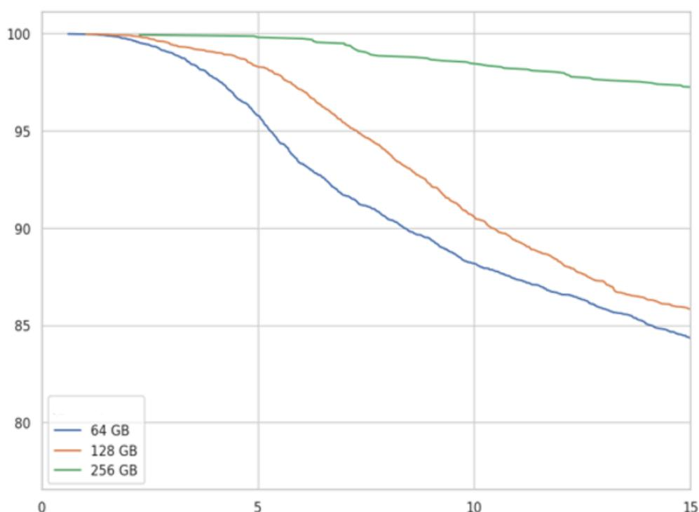
Figure 2. Courbe des percentiles cumulés pour les durées de vie des cartes de surveillance, illustrant le pourcentage de cartes qui fonctionnent encore après 0 à 15 ans. Simulation basée sur des données et des estimations réelles.
