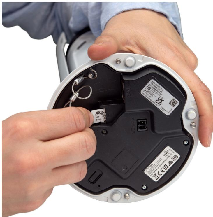
Figure 1. Carte de surveillance dans une caméra Axis.
