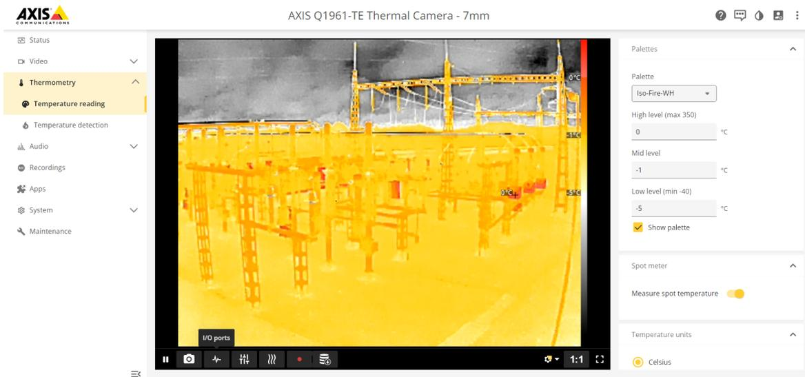
*AXIS Q1961-TE Thermal Camera (熱顯像攝影機)的螢幕截圖。使用者按一下可查看特定區域的溫度。*
