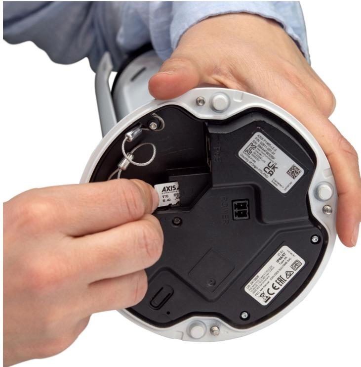
Figure 1. Una tarjeta de vigilancia en una cámara de Axis.
