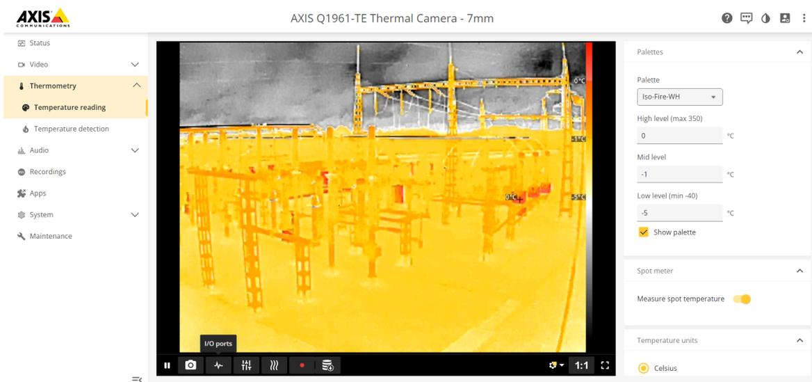
Capture d'écran de la caméra thermique AXIS Q1961-TE Thermal Camera. L'utilisateur a cliqué sur un point particulier pour en consulter la température.
