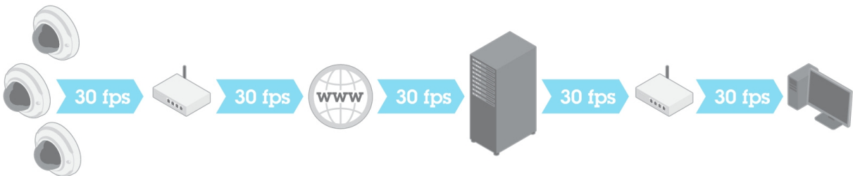
Figure 1. 모든 단계에서 30 fps의 제어된 프레임 레이트를 이용하는 감시 시스템. 카메라의 프레임 레이트는 전체 시스템 성능이 충분한 경우에만 시스템 전체에서 유지될 수 있습니다.
