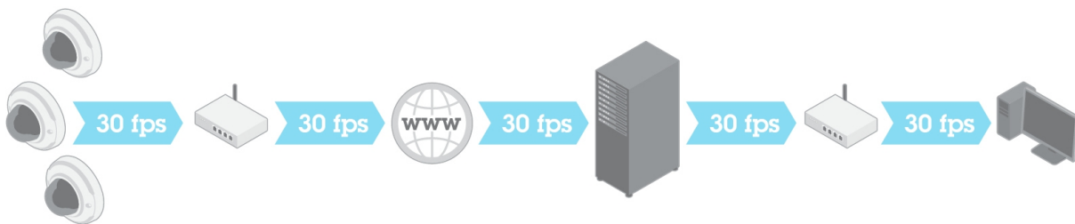
Figure 1. Système de surveillance où la fréquence d'image est contrôlée à 30 ips à chaque étape. La fréquence d'image de la caméra ne peut être préservée dans l'ensemble du système que si ses performances globales sont suffisantes.
