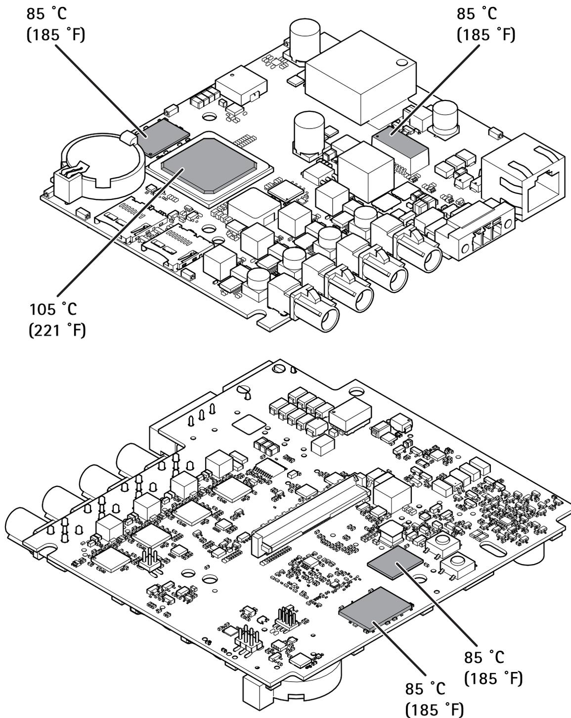
*Températures maximales autorisées. Si la température ambiante est de 35 °C (95 °F) ou supérieure, la température des composants augmente et ils doivent être refroidis.*
