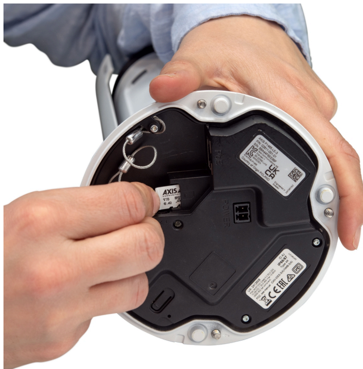
Figure 1. Eine Überwachungskarte in einer Axis Kamera.
